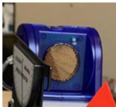
FIGURE 25 – Capteur à ultrason
