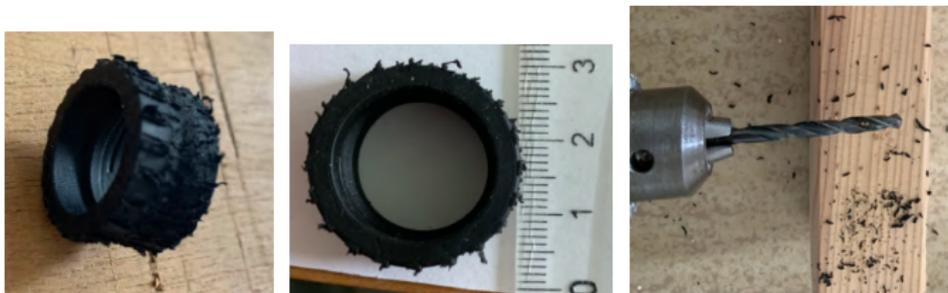
FIGURE 8 – Pneu usé par frottement sur du bois
